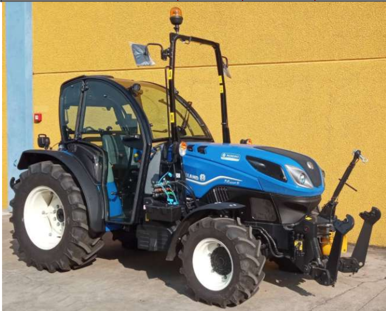
Cabina “COMPACT” NEW HOLLAND T4.100F S Gommatura posteriore Trattore 380/70 R.24
